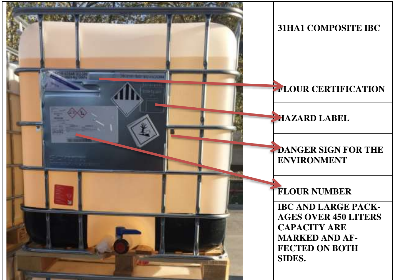
IBC (OHK) Labeling
